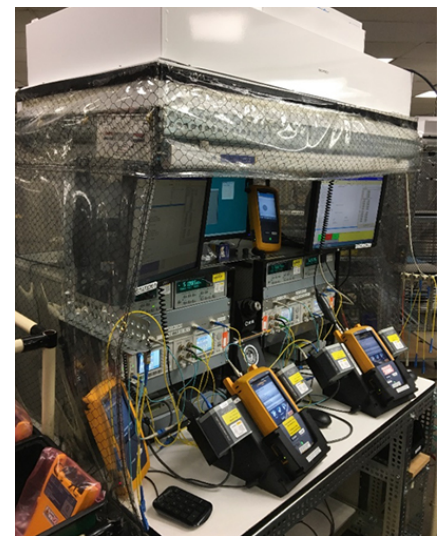
Figura 2: Estación de calibración de fibra. Observe el plástico que rodea la estación en el sistema de filtrado en la parte superior para reducir el polvo. Fluke Networks modifica algunos de los productos disponibles comercialmente para que cumplan nuestros requisitos de precisión.
