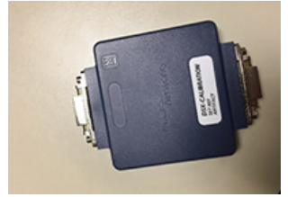
Figura 3: Uno de los diecisiete artefactos de calibración de cobre que se usan en nuestros centros de servicio. Recubierto de un maletín rígido de plástico para su protección.
