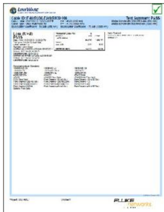
Informe de LinkWare con prueba de flujo restringido (Encircled Flux) y latiguillos de comprobación comprobados
